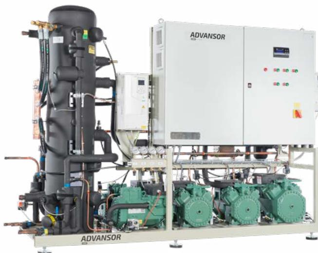
Un design semplice, compatto, e di facile manutenzione. Value Pack è adatto a tutti i supermercati e applicazioni industriali di medie dimensioni, con un'ampia gamma di opzioni a disposizione del cliente. Il design è ottimizzato dai compressori concentrati su un unico livello, dal quadro elettrico in alto, e dal ricevitore a sinistra dei compressori. Le tubazioni sono K65.
